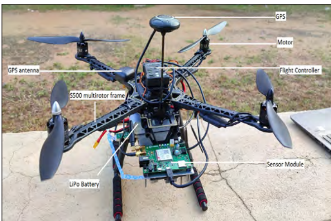
चित्र 4.1: यू.ए.वी. पर लगा हुआ आई.ओ.टी. संवेदक मॉड्यूल Fig. 4.1: IoT Sensor Module mounted on UAV
