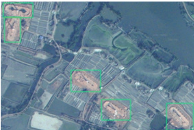
चित्र 6.1: भुवन बिम्ब व्यूह में ईंट भट्टे का पता लगाना Figure 6.1 : Brick kiln detection in BHUVAN imagery.
