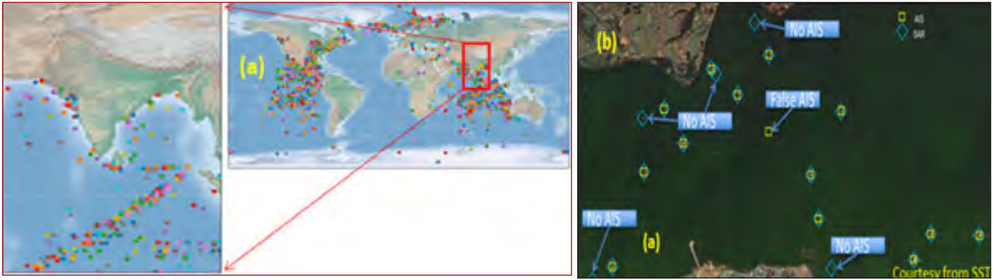
चित्र 15.1: एआईएस डेटा से शिप स्थान और समुद्री सार डेटा से पता चले जहाज के साथ इसका संबंध Figure 15.1: Ship locations from AIS data and its association with detected ship from maritime SAR data
