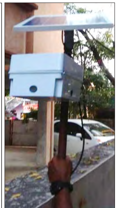
चित्र 13.1: IoT सेंसर का उपयोग कर वायु प्रदूषण निगरानी उपकरण प्रणाली आर्किटेक्चर फील्ड में स्थापित IoT सेंसर को दिखाया गया है Figure 13.1: Air Pollution Monitoring Instrument System Architecture using IoT sensors. IoT sensor installed in the field is shown
